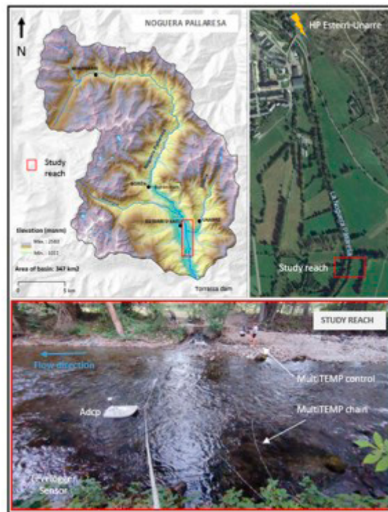
Figure 5. Location of the studied reach of the Noguera Pallaresa River in the upper Noguera Pallaresa basin. In the reach, it is possible to observe i) the MultiTEMP control unit (right bank) and the sensor chain crossing the section of the river, ii) the location of the Levellogger water depth and temperature sensor (left bank), and iii) the SonTek® M9 aDcp registering water depth and flow velocity. The position of the control unit corresponds to the GNSS-referenced deployment location (42.619243°N, 1.128180°E). Ubicación del tramo del río Noguera Pallaresa en el área de estudio de la cuenca alta de la Noguera Pallaresa. En el tramo estudiado pueden observarse: i) la unidad de control MultiTEMP (margen derecha) y la cadena de sensores cruzando la sección del río; ii) la ubicación del sensor Levellogger de profundidad y temperatura del agua (margen izquierda); y iii) el equipo Sontex® M9 aDcp registrando la profundidad y la velocidad de flujo. La posición de la unidad de control corresponde a la ubicación de despliegue georreferenciada mediante GNSS (42.619243°N, 1.128180°E).
